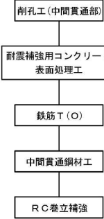
橋脚耐震補強施工要領
